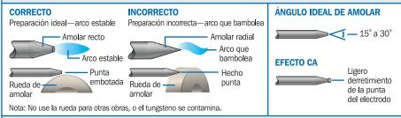
Consejo: Se hace la punta del electrodo un poco más mocha para ayudar a mantener la geometría consistente y resistir la erosión del tungsteno. Esto es especialmente bueno en CA cuando el derretimiento del electrodo tungsteno es común.
